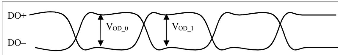
**Figure 26.**  $V_{OD}$  AC
