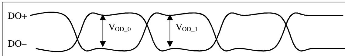
**Figure 24.  $V_{OD}$  AC**
