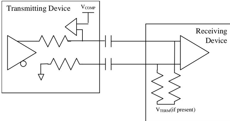
**Figure 18. AC Detect Circuit**
