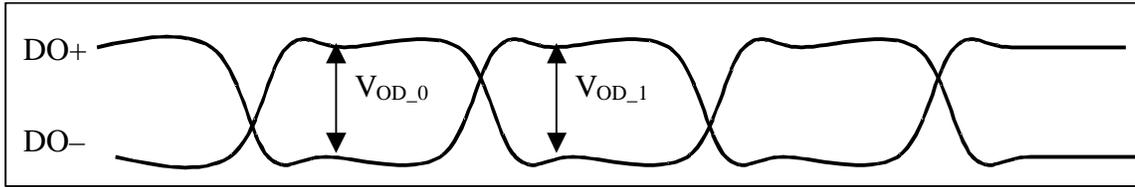
**Figure 37.  $V_{OD}$  AC**
