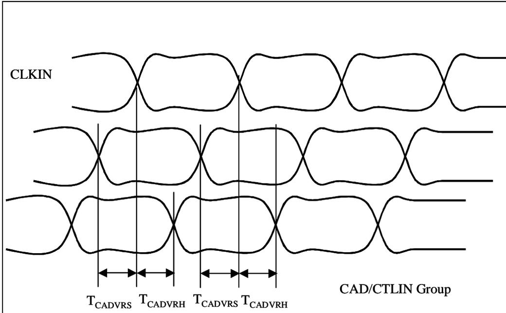
Figure 47.  $T_{CADVRS}/T_{CADVRH}$
