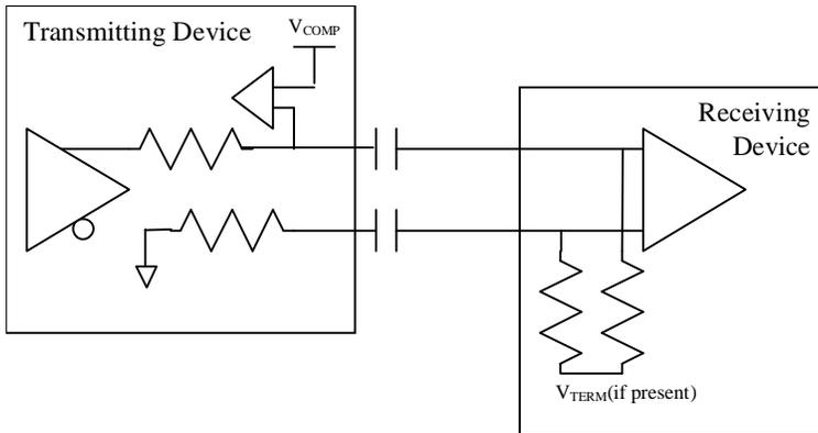
**Figure 18. AC Detect Circuit**
