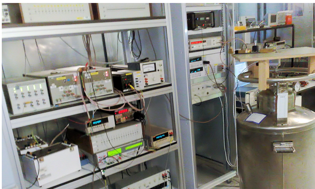
Figura 4.14 – Imagem do sistema de medição do potenciômetro de Josephson, no interior da câmara blindada de EJ.
