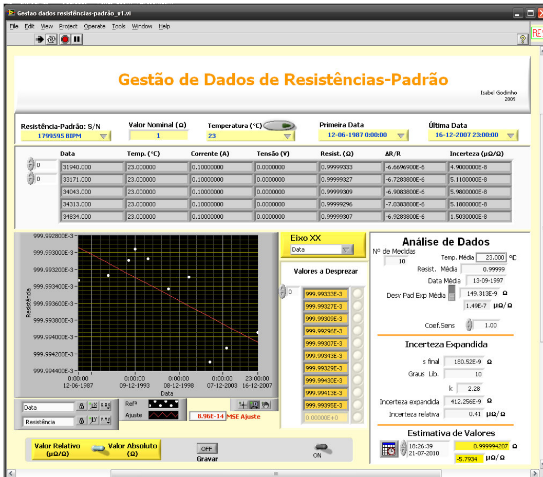
Figura 4.23 – Painel frontal de um módulo aplicativo para a gestão de dados de resistências-padrão.
