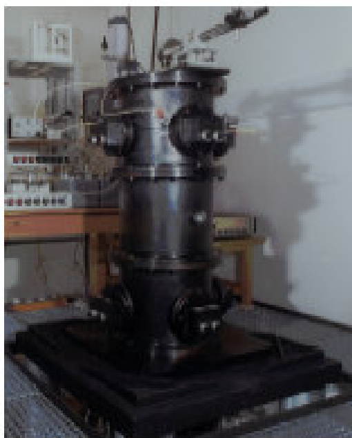
Figura 2.6 – Imagem do sistema experimental do condensador calculável de Thompson-Lampard implementado no CSIRO.
