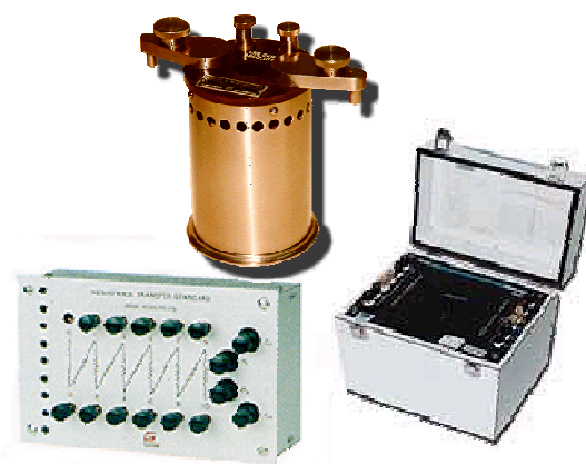
Figura 3.20 – Resistências-padrão de valor nominal 1 \Omega e 10 k \Omega e padrões de transferência tipo Hamon .
