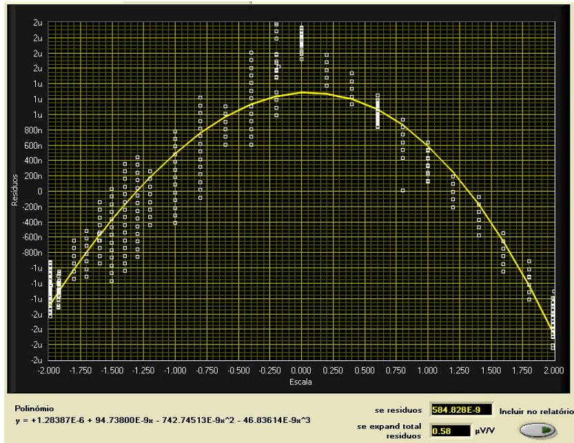
Figura 4.9 – Determinação do erro de linearidade para o voltímetro utilizado na medição de V_H , para o intervalo de medição \pm 2 V.
