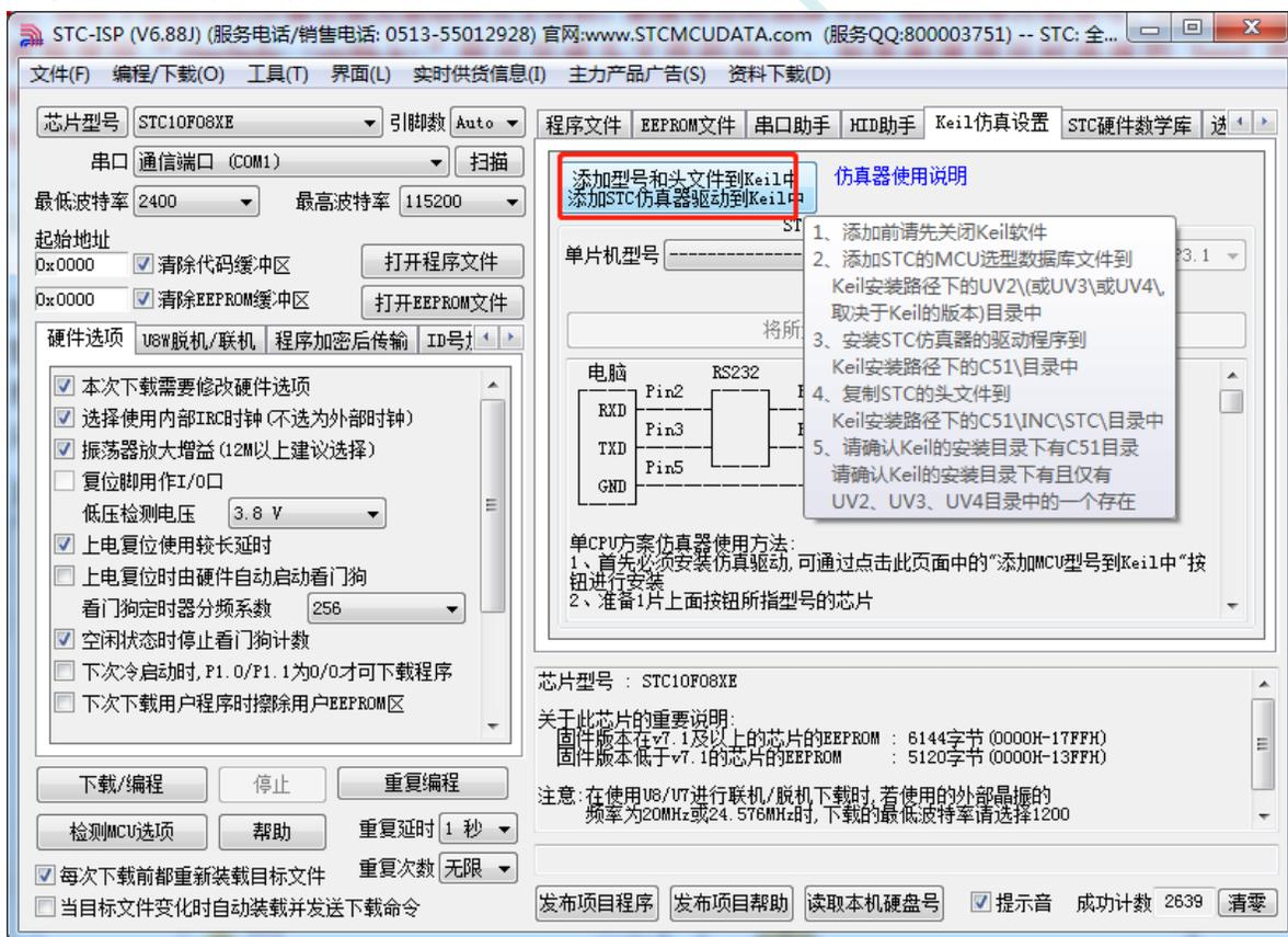
如上图，首先选择“Keil 仿真设置”页面，点击“添加 MCU 型号到 Keil 中”，在出现的如下的目录选择窗口中，定位到 Keil 的安装目录（一般可能为“C:\Keil\”），“确定”后出现下图中右边所示的提示信息，表示安装成功。添加头文件的同时也会安装 STC 的 Monitor51 仿真驱动 STCMON51.DLL，驱动与头文件的安装目录如上图所示。
