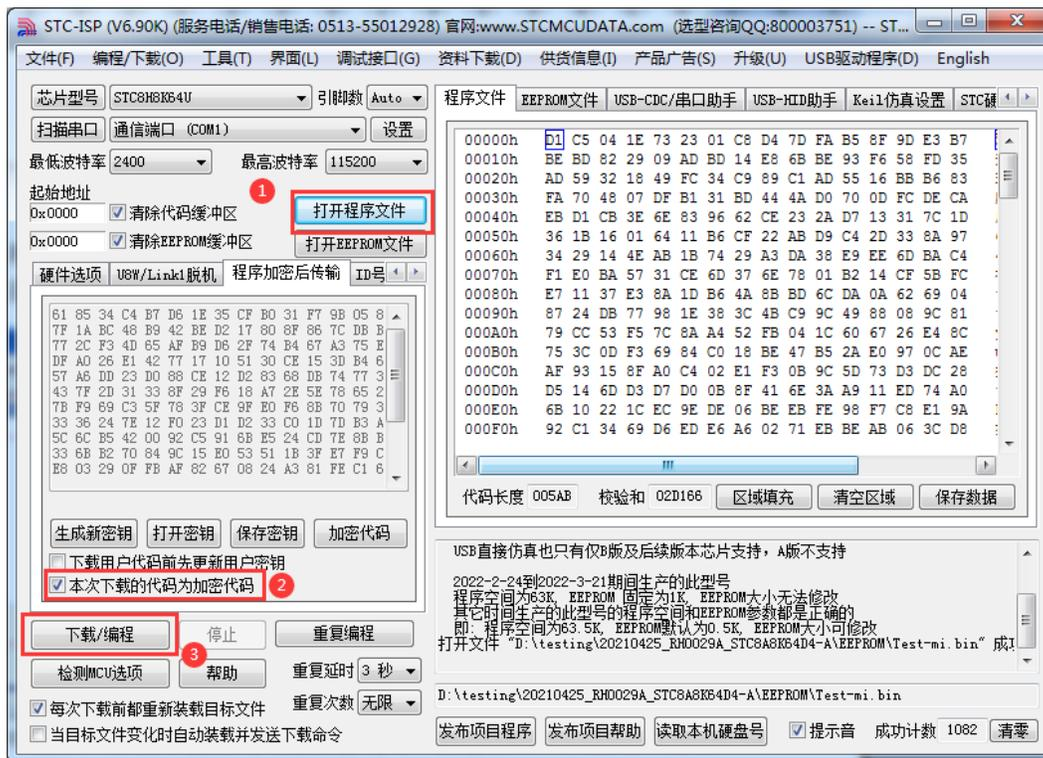
对于一片新的 STC 单片机, 可将步骤 3 和步骤 4 合并完成, 即将密钥更新到目标单片机的同时也可将加密后的代码一并下载到单片机中, 若已经执行过步骤 3 (即已经将密钥更新到目标芯片中了), 则后续的代码更新就只需要按照步骤 4, 只需要在“程序加密后传输”页面中选择“本次下载的代码为加密代码”的选项 (“下载用户代码前先更新用户密钥”选项不需要选了), 然后打开我们之前加过加密后的文件, 打开后点击界面左下角的“下载/编程”按钮, 按正常方式对目标芯片下载即可完成用用户自己专用的加密文件更新用户代码的目的 (防止在烧录程序时被烧录人员通过监测串口分析出代码的目的)。
