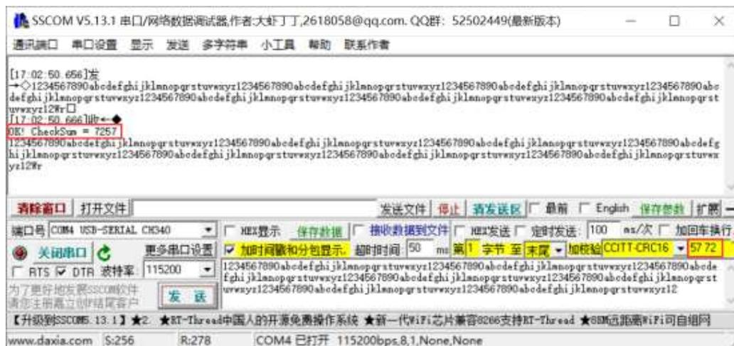
MCU 收到整包数据 (256 字节) 之后对前面 254 字节数据进行 CRC16 校验, 得出来的校验码与最后两个字节进行比较, 如果数值相等, 打印 “OK!” 以及计算出来的校验码, 然后输出 DMA 空间收取的内容。
