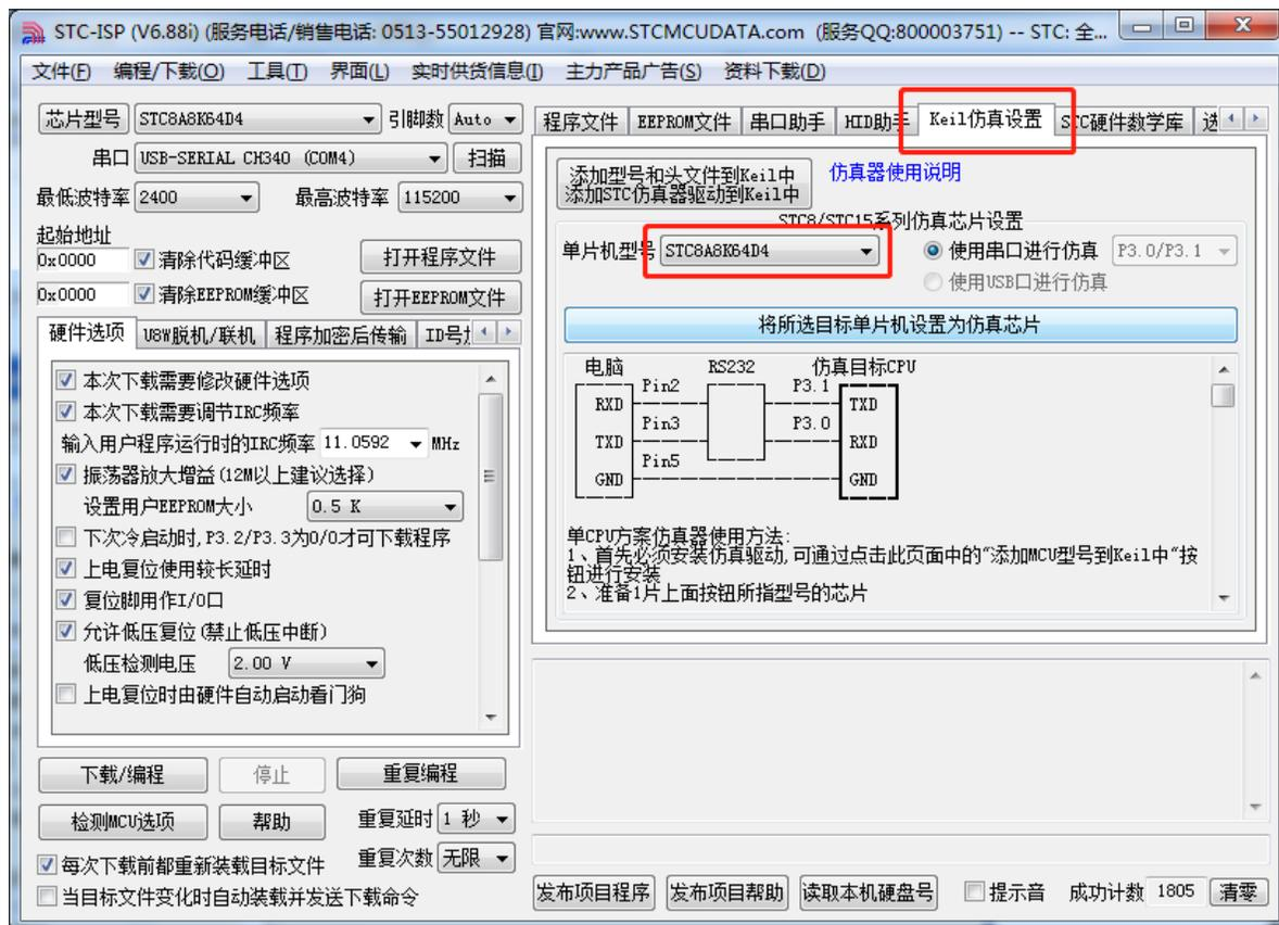
准备一颗 STC8A 系列或者 STC8F 系列的芯片，并通过下载板连接到电脑的串口，然后如上图，选择正确的芯片型号，然后进入到“Keil 仿真设置”页面，点击相应型号的按钮，当程序下载完成后仿真器便制作完成了。
