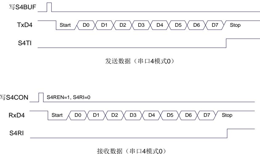
串口 4 的波特率是可变的, 其波特率可由定时器 2 或定时器 4 产生。当定时器采用 1T 模式时 (12 倍速), 相应的波特率的速度也会相应提高 12 倍。
