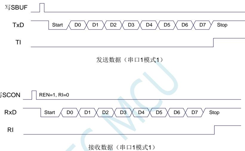
串口 1 的波特率是可变的, 其波特率可由定时器 1 或者定时器 2 产生。当定时器采用 1T 模式时(12 倍速), 相应的波特率的速度也会相应提高 12 倍。
