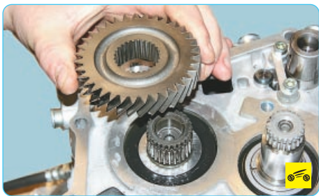
27. ...и спрессуйте шестерню с вала.
