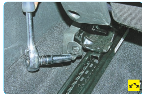
2. Выверните болт крепления ремня безопасности к салазкам переднего сиденья...
