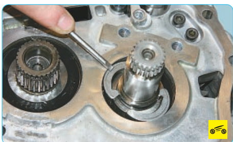
29. ...и извлеките два упорных полукольца.
