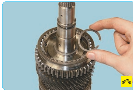
12. ...снимите стопорное кольцо...
