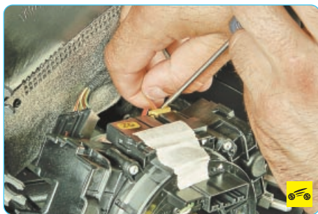
17. Отожмите отверткой фиксатор желтой колодки жгута проводов...
