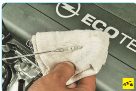
15...протрите его чистой тряпкой и снова вставьте на место.
