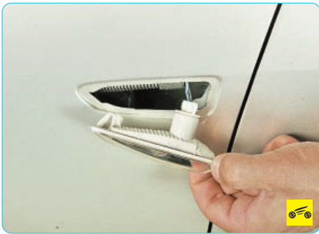
3. ...и извлеките его из крыла.
