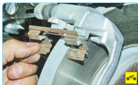
9. ...и верхнюю прижимные пружины колодок и осмотрите их.
