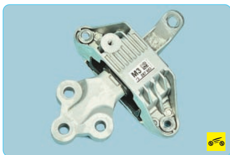
10. Осмотрите подушку опоры. При наличии вспучивания, растрескивания массива
