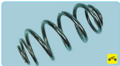
Пружины 4 (см. рис. 7.3) подвески переменной жесткости (бочкообразные).
