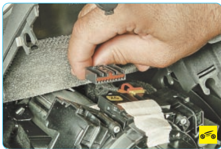
14. ...и отсоедините колодку от контактного кольца.
