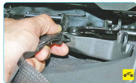
3. ...поверните бугель ремня вниз, чтобы совместить увеличенную по диаметру часть отверстия в бугеле с пальцем на салазках сидений...
