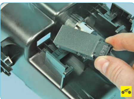
10. ...и извлеките разъем из блока.
