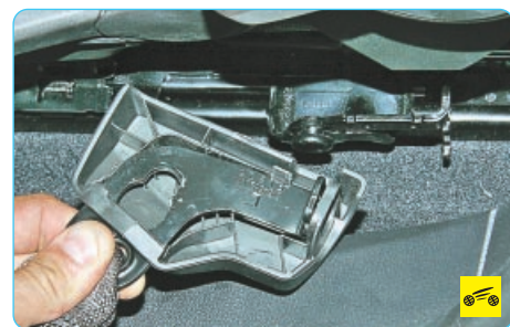
3. ...поверните бугель ремня вниз, чтобы совместить увеличенную по диаметру часть отверстия в бугеле с пальцем на салазках сидений...
