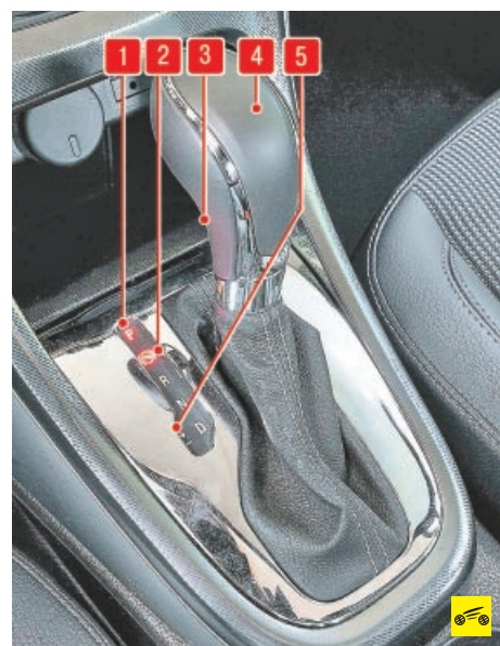
Рис. 1.9. Рычаг селектора управления автоматической коробкой передач: 1 – шкала автоматического режима управления; 2 – сигнальная лампа необходимости нажатия на педаль тормоза; 3 – кнопка блокировки включения передачи; 4 – рукоятка рычага; 5 – шкала ручного режима
