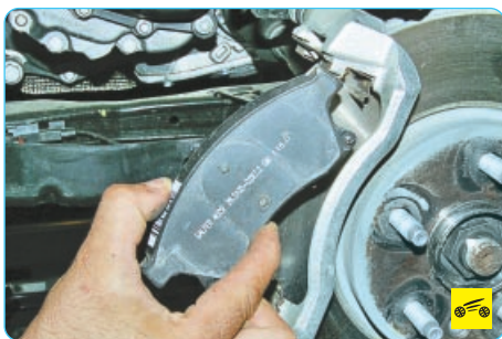
7. ...и наружную тормозные колодки.
