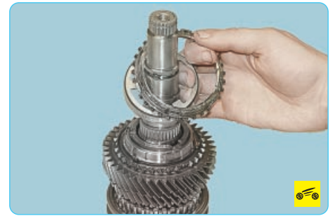
16. Снимите наружное блокирующее кольцо, промежуточное кольцо...
