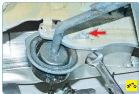
1. Выверните болт крепления...
