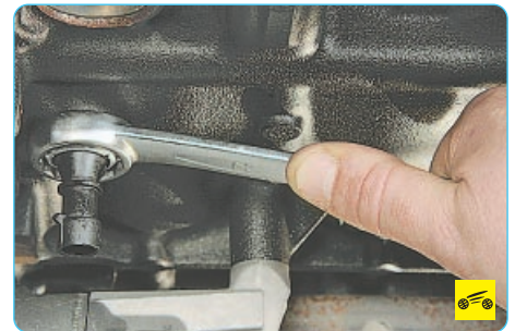
5. Ослабьте затяжку датчика...
