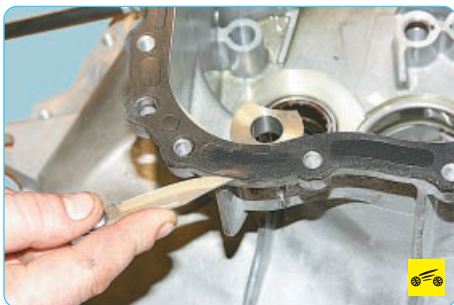
33. Снимите прокладку картера, отделив ее острым ножом.
