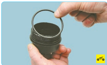
10. ...снимите с крышки резиновое уплотнительное кольцо.
