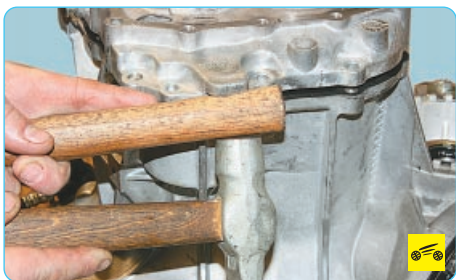
31. ...отделите промежуточный картер от картера коробки ударами молотка через деревянную проставку, опертую о специальный прилив картера...
