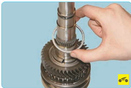
20. Снимите запорное кольцо...
