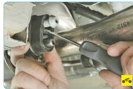
3. Для замены подушек подвески основного глушителя сдвиньте заменяемую подушку отверткой с кронштейна на кузове, затем с кронштейна глушителя...
