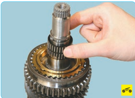
7. ...игольчатый подшипник ведомой шестерни I передачи...
