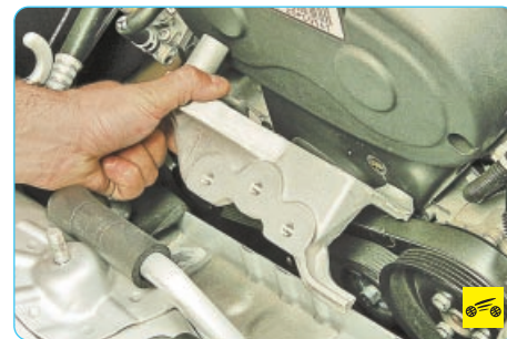
6. ...и снимите кронштейн.
