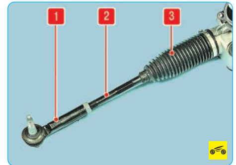
Рис. 8.2. Рулевая тяга: 1 – наконечник правой рулевой тяги; 2 – рулевая тяга; 3 – защитный чехол
