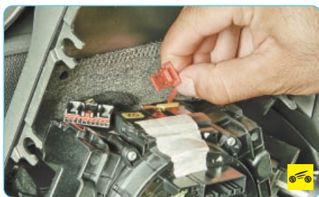
16. ...извлеките замок из колодки.
