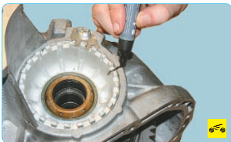
36. Пометьте положение регулировочной гайки подшипников дифференциала относительно картера коробки передач.
