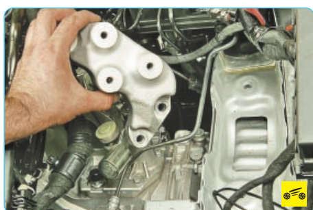
9. ...и снимите кронштейн.
