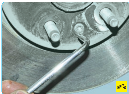
4. Выверните болт крепления диска к ступице...
