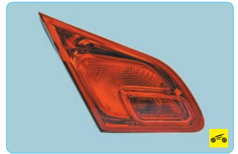
8. ...и снимите фонарь.
