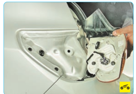
4. ...и отсоедините фонарь от кузова, выведя его фиксаторы из отверстий в кузове.
