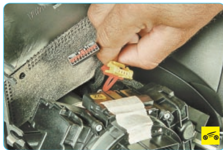
18. ...и отсоедините колодку от контактного кольца.
