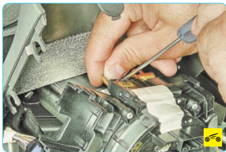
13. Отожмите отверткой фиксатор верхней черной колодки жгута проводов...
