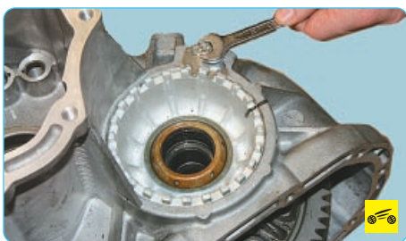
36. Пометьте положение регулировочной гайки подшипников дифференциала относительно картера коробки передач.
