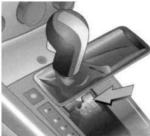
Fig. 1.227. Detent selector lever
