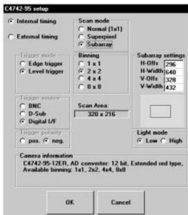
C4742-95-12ER setupダイアログボックス (Subarrayモード)
