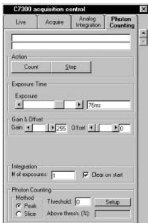
フォトンカウンティングコントロールボックス(C7300-10カメラ)
