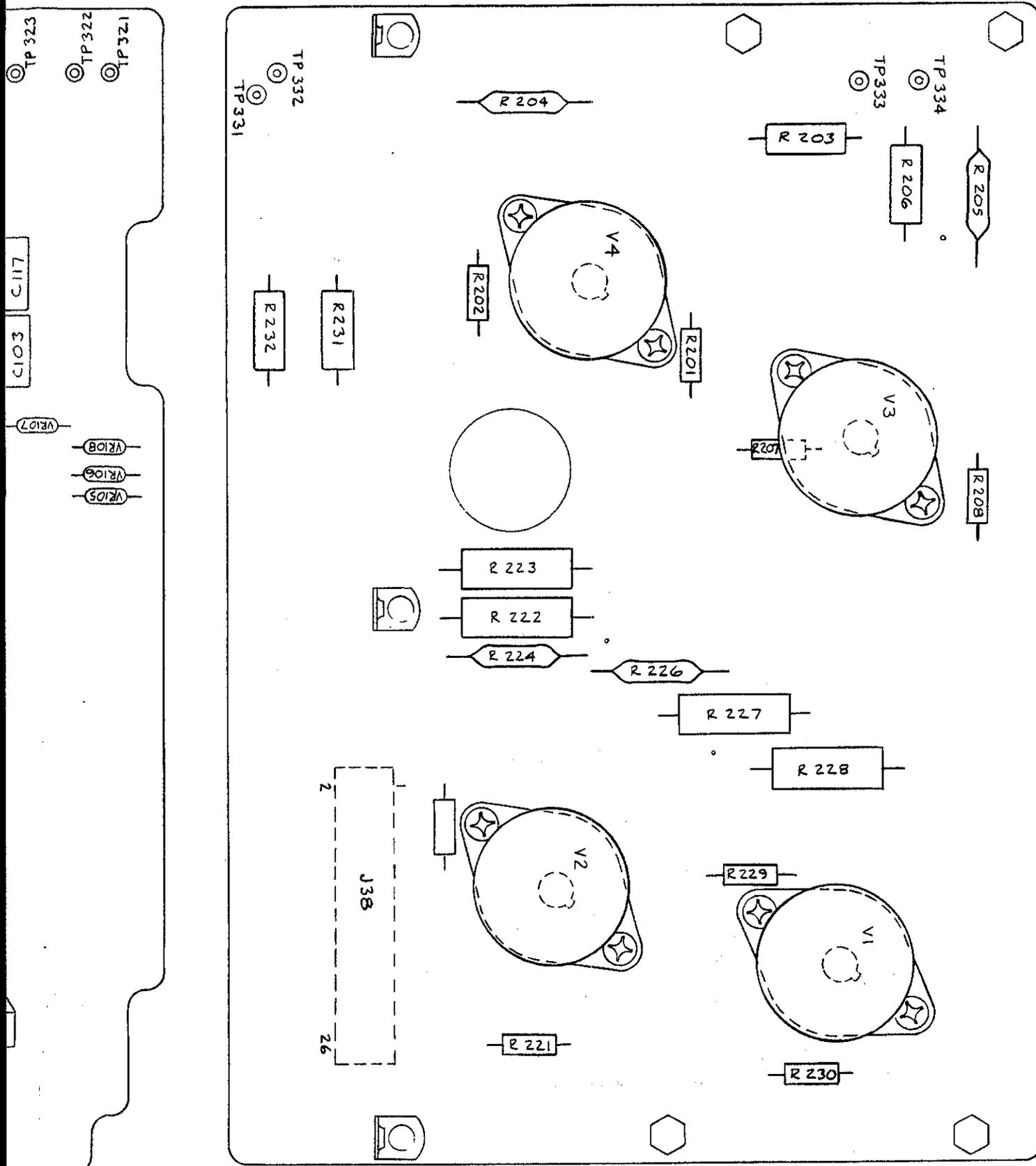
FIGURE 8-10. POWER AMPLIFIER LOWER TUBE ASSEMBLIES COMPONENT LOCATION
