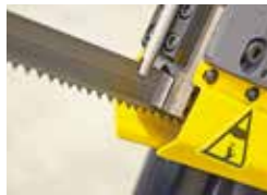
Sägebandführung aus Hartmetall
