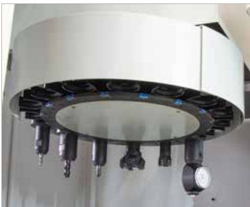
10-fach Werkzeugwechsler S 400
