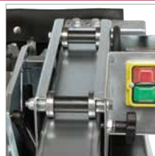
Leichtgängiger Rollschlitten auf Präzisionslagern
