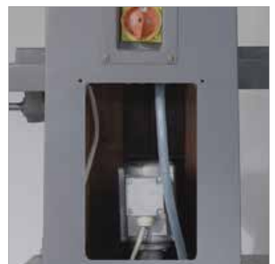
Kühlmittelpumpenmotor 90 W, Pumpleistung 25 l/min, Tank im Maschinensockel
