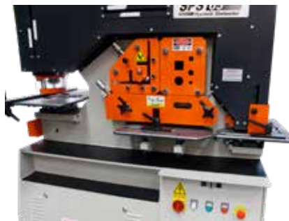
Stabstahlstation / Profilstahlstation / Flachstahlstation
