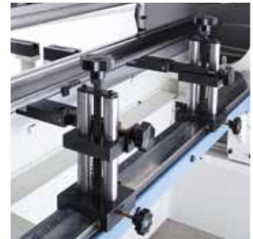
Standard: Präzises Hinteranschlagsystem der X-Achse mit AC-Antrieb
