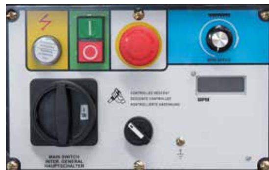
CY 210-2GN Vario | CY 260-2GN Vario Zentrales Bedienpanel mit digitaler Schnittgeschwindigkeitsanzeige, versperrbarem Hauptschalter, Not-Aus-Taster
