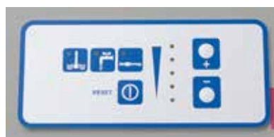
Bedienpult mit Tastatur, Led's & 5-stufiger Heizleistungs-Regelung
