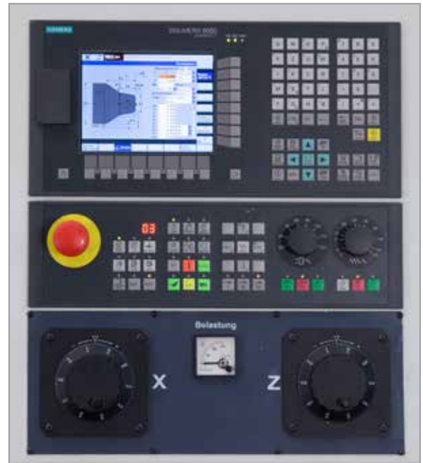
Steuerpanel mit 2 elektronischen Handrädern
