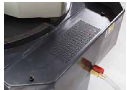
Spänewanne mit Kühlmittelbehälter, Abb. Rücklauffilter und Dosierventil
