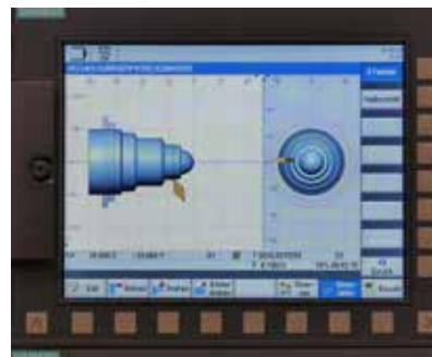
Steuerpanel SIEMENS SINUMERIK 828D
