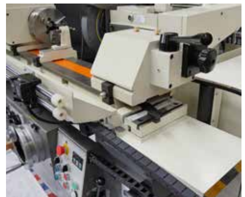
Arbeitsbereich mit integrierter Abziehvorrichtung
