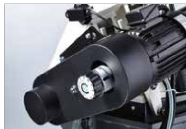
Stufenlos einstellbarer Schnittgeschwindigkeitsregler mit 12 Einstellbereichen 0-11 und Bandgeschwindigkeitsanzeige
