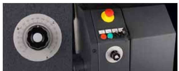
Manuelle Winkeleinstellung mittels Potentiometer
