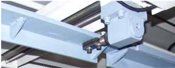
NC-gesteuertes Hinteranschlagsystem für automatische Positionierung und Rückstellung über Kugelumlaufspindel
