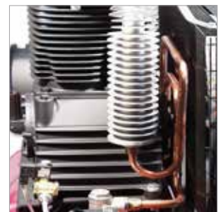
Kühler aus Alu- Druckguss und Kupferkühlleitung
