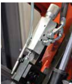
Hydraulische Schnittdrucküberwachung bei DGH-Modelle
