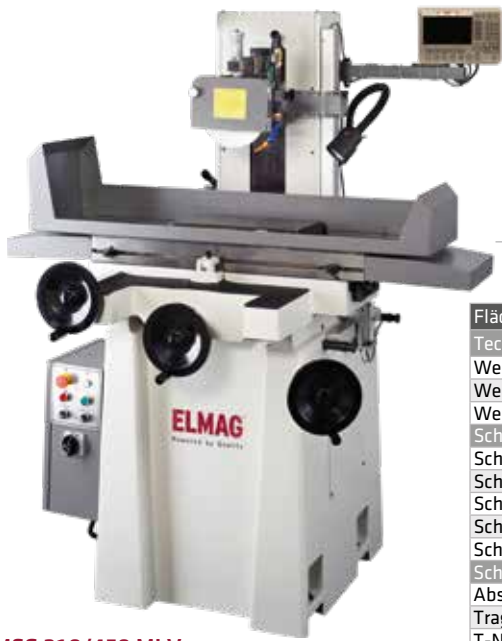
SINO Zweiachs-Positionsanzeige für rasche, hochpräzise Ein- und Zustellung der Quer- und Vertikalachse
