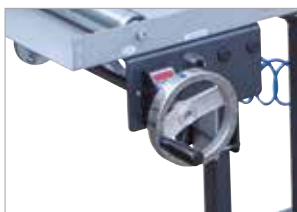
Type EXAKT A 350/450: Handrad mit Digitalanzeige
