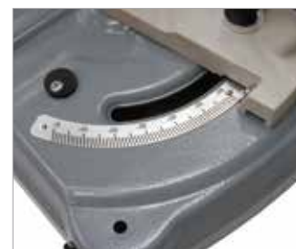
Gut ablesbare Winkelskala - einfache Gehrungseinstellung 0 bis 60°
