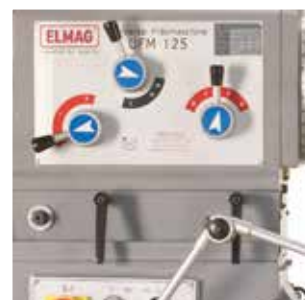
UFM 125 Spindelgetriebe mit Schnellschaltelementen
