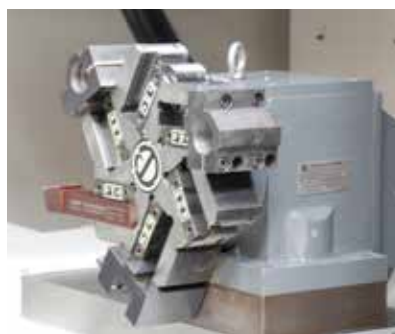
6-fach Werkzeugrevolver serienmäßig
