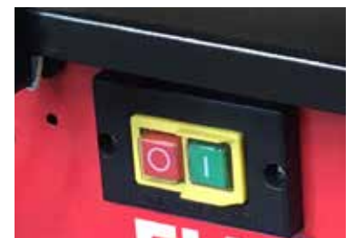
Sicherheitsschalter mit Nullspannungsauslöser
