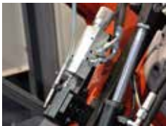
Hydraulische Schnitt- drucküberwachung bei DGH-Modelle
