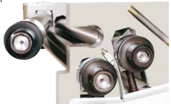
Sonderzubehör ASM-S: Verlängerte Walzen mit Profilrollen
