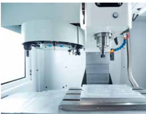
16-fach Werkzeugwechsler S 650
