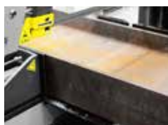
Schnittbereich bis 510 mm
