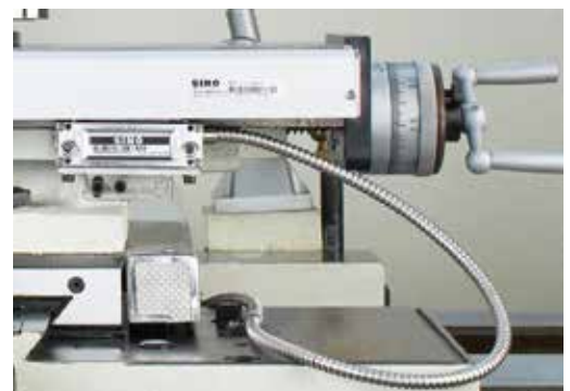
Oberschlitten mit Ableseeinheit auf einer Universal Drehmaschine
