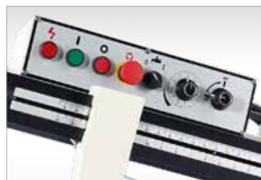
Steuerpanel mit Betriebslampe, Start-, Stopp-, Not-Aus-Taster, Kühlmittelpumpe O/I, Absenkautomatik mit Regelventil 0-10 und Absperrventil ON/OFF
