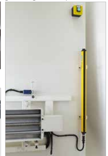
Rückseite: Lichtschranke mit Prüfeinrichtung
