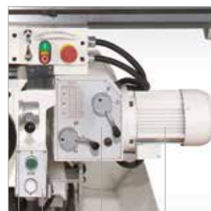
UFM 125 Spindelgetriebe mit Schnellschaltelementen
