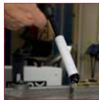
Automatische Elektrolyt-Zufuhr per Knopfdruck
