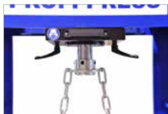
Verchromter Kolben mit abschraubbarem Deckel
