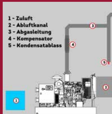
Wassergekühlte Stromerzeuger offen
