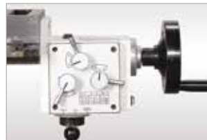
Kreuztisch X-Achse mit acht Vorschubstufen und Eilgang
