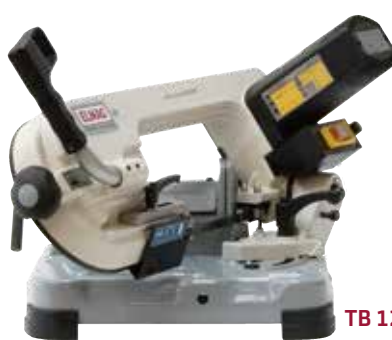
Stufenlos einstellbare Schnittgeschwindigkeit TB 125/150
