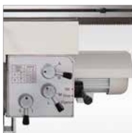
Kreuztisch-Vorschubgetriebe mit Eilgang
