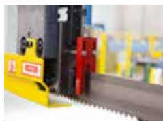
Sägebandführung aus Hartmetall
