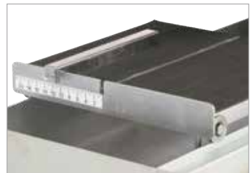
Präzise: Justierbarer Längsanschlag, Messskala
