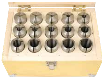
Spannzangen-Set MK 4 / M16, direktspannend
