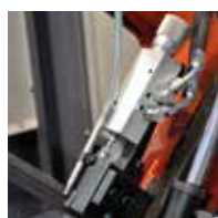
Hydraulische Schnittdrucküberwachung bei DGH-Modelle
