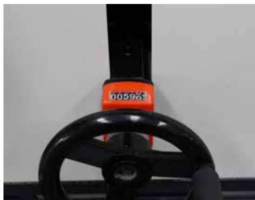
Mechanische Messeinrichtung des Hinteranschlags
