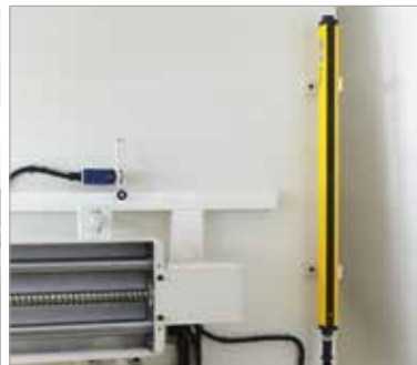
Erhöhte Sicherheit - CE-Lichtschranke von SICK
