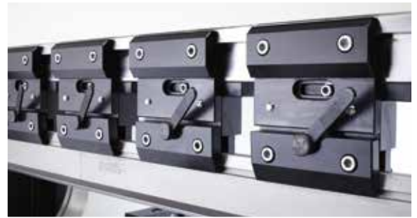
Oberwerkzeughalterung mit Schnellwechselsystem
