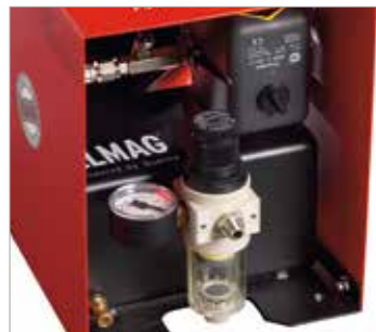
CONDOR Druckschalter, Filter-Druckminderventil, Systemdruckmanometer
