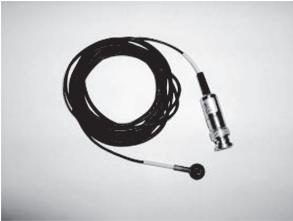
FIG. V-4. PTW VIVODOS E diode system.
