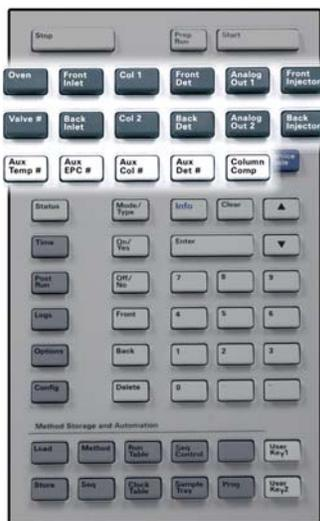
Essas teclas são usadas para ajustar a temperatura, a pressão, o fluxo, a velocidade e outros parâmetros operacionais de método.
