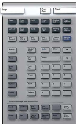
**[Prep Run]** Ativa os processos necessários para deixar o GC na condição de partida ditada pelo método (como desativar o fluxo de limpeza de entrada para uma injeção sem divisor ou restauração de fluxo normal a partir do modo de economizador de gás). Consulte o [Guia do usuário avançado](#) para obter detalhes.
