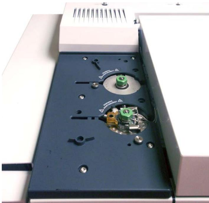
As amostras podem ser injetadas nas entradas manualmente com o uso de uma seringa ou com um dispositivo de amostragem automático (como um Amostrador de líquidos automático da Agilent ou um Amostrador de espaço no cabeçote da Agilent).
