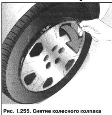
Рис. 1.255. Снятие колесного колпака
