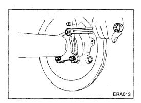
• Tighten nuts to the specified torque. [7]: 53 - 63 N·m (5.4 - 6.4, 39 - 46)
