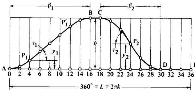
Fig. 17. Displacement Diagram
