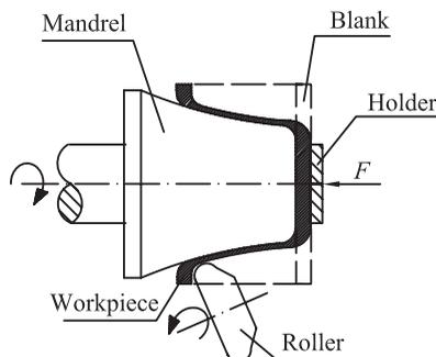
Fig. 23. Shear Spinning
