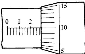
Fig. 3. Inch Micrometer
