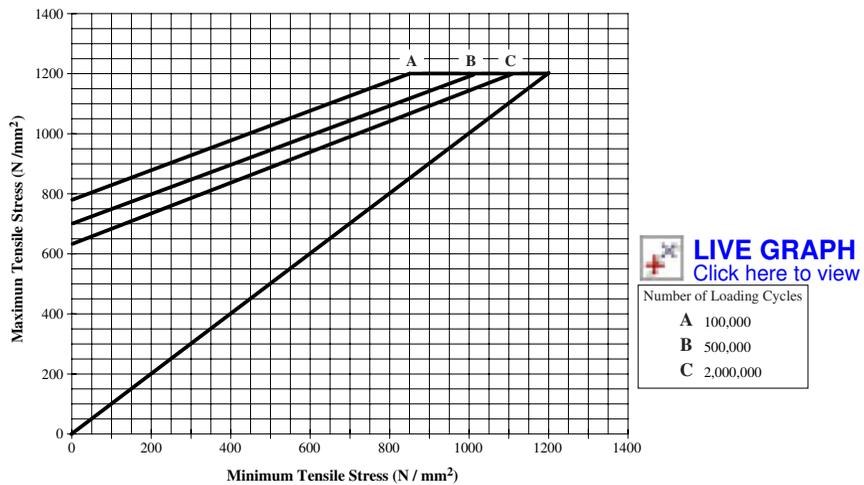
Fig. 12. *Group 3* Diagram for Estimating Fatigue Life of Disc Springs ( $6 < t \leq 16$  mm)
