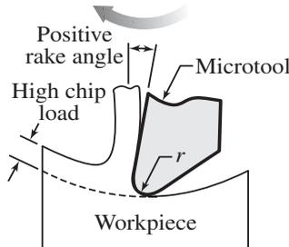
Fig. 2d. (d) Micromilling, chip load  $> 0.5 r$ .
