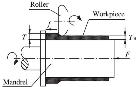
Fig. 24. Tube Spinning
