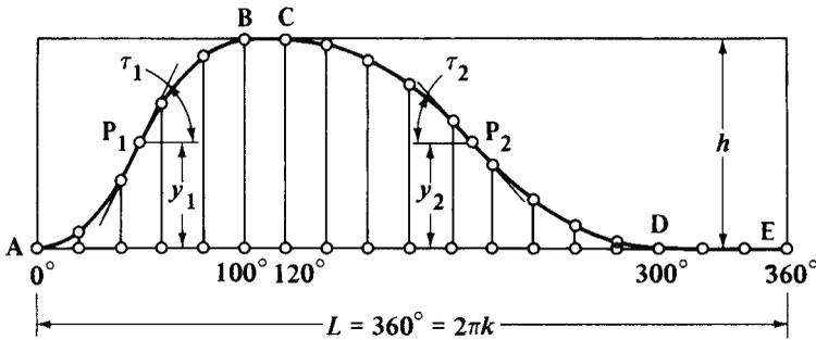
Fig. 13. Displacement Diagram
