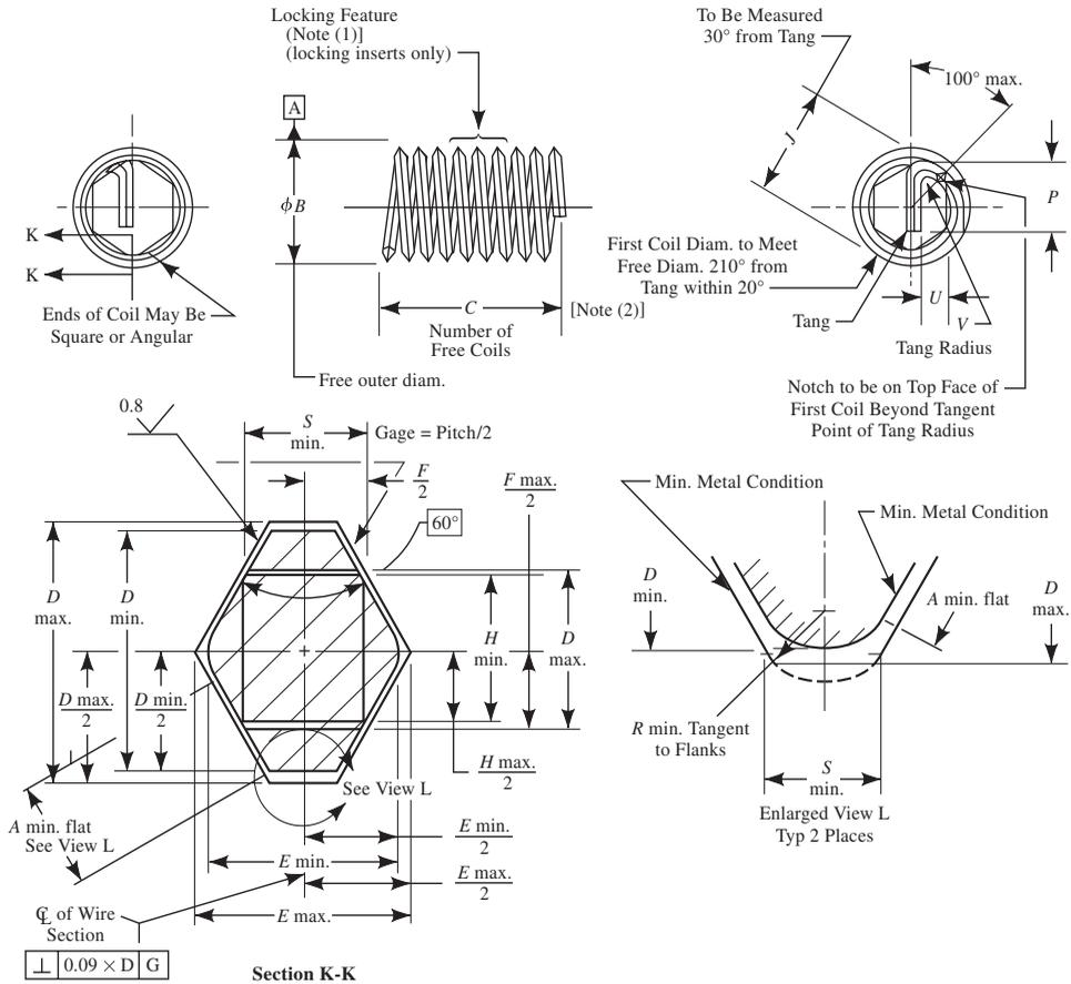
Fig. 2. Insert Configuration
